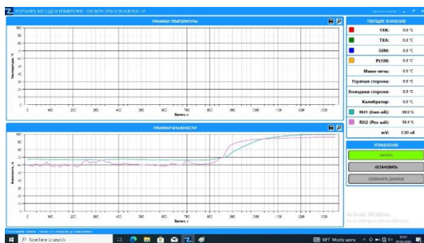
Рисунок 2. График зависимости показаний относительной влажности резистивного и ёмкостного датчика от времени.
