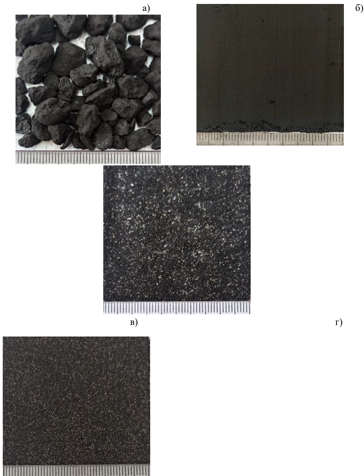
Рис.5. Фотографии фракций бурого угля при измельчении в турболопастном аппарате. а – исходная фракция - 12-15 мм; б – 0,5-0,63 мм; в – 0,16-0,315 мм; г – <0,05 мм;
